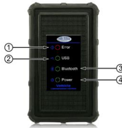
2. ábra -5 VCI dongle előső nézete
